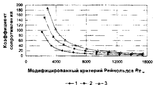
Рис. 6 – Зависимость коэффициента гидравлического сопротивления аппарата от модифицированного критерия Рейнольдса.
