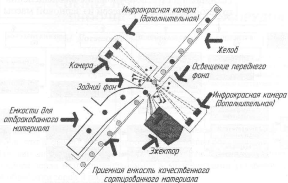
Рисунок 2 – Принципиальная схема работы фотоэлектронного сепаратора
