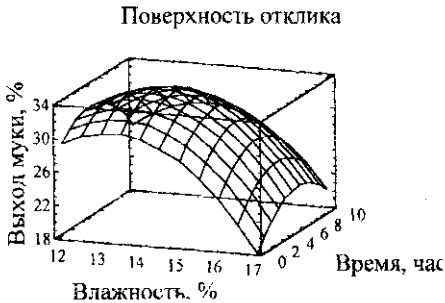
Рис. 12 Результаты оптимизации режимов холодного кондиционирования зерна ржи
