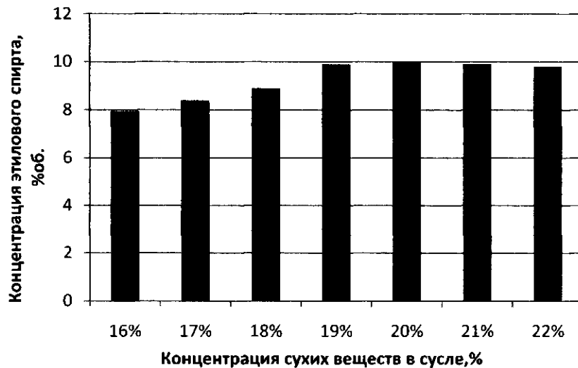
Рисунок 4 – Влияние содержания сухих веществ сусла на накопление дрожжами расы CD этилового спирта
