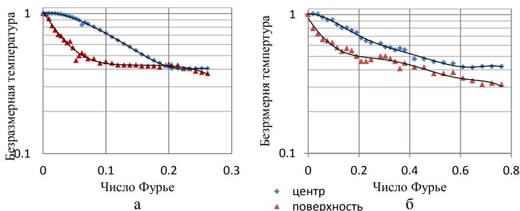
а – образец  $d=5\text{см}$ ; б – образец  $d=2,75\text{см}$
