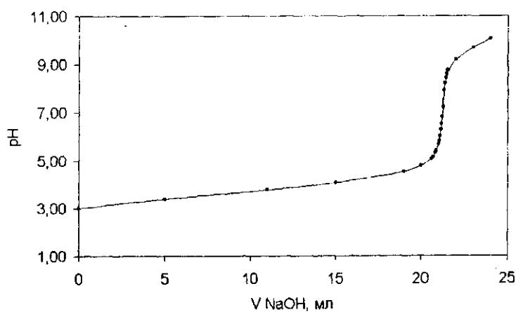
Разработанная потенциометрическая методика с использованием защищенных специальной композицией электродов позволила получить высокую точность определения плавиковой кислоты ( $\pm 0,1 - 0,2 \%$ ).
