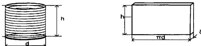
$d$  – диаметр пружины;  $h$  – высота пружины;  $\delta$  – диаметр проволоки пружины.
