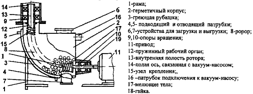
Рисунок 29 – Сушильный аппарат емкостного типа с пружинным рабочим органом и дополнительными мелющими телами
