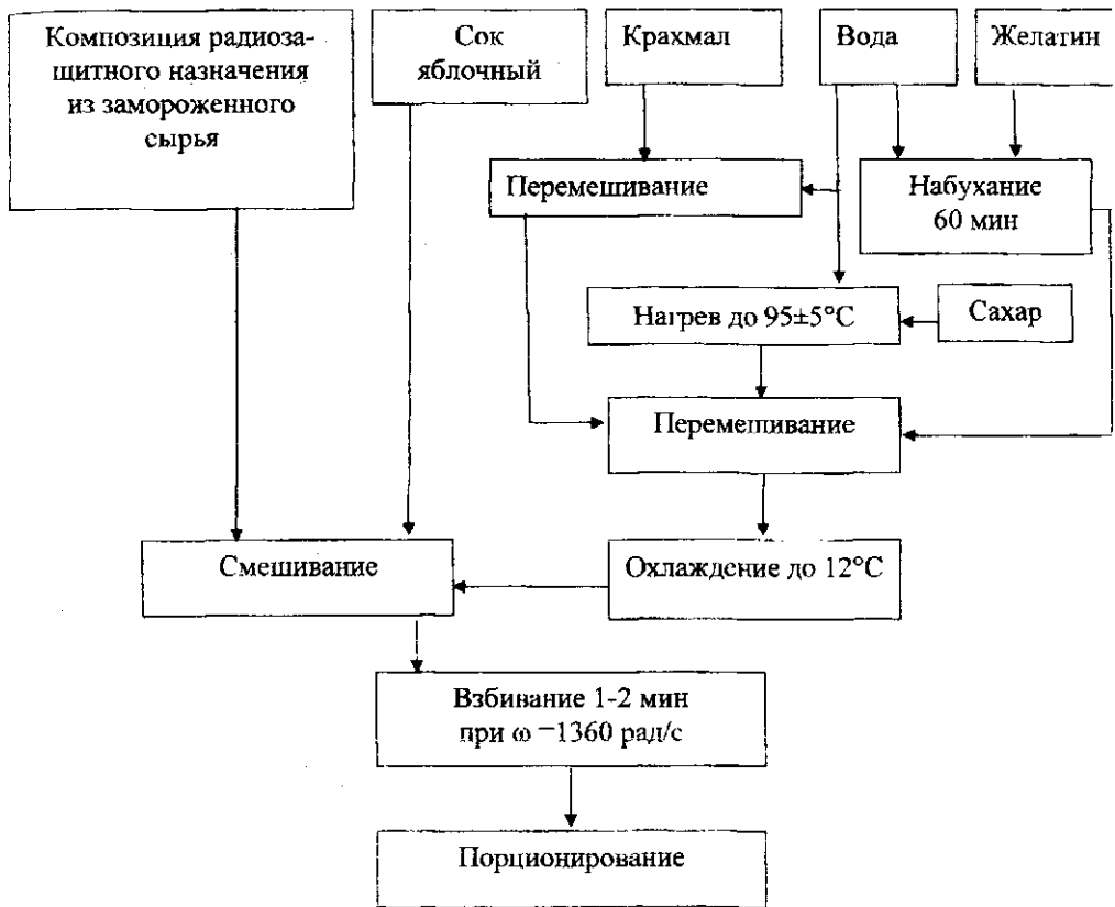
Рис. 5 Технологическая схема производства вспененного напитка радиозащитного назначения
