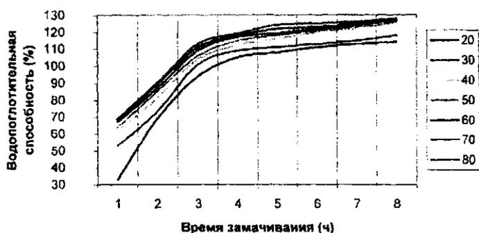
Исследования проводили в интервале температур 20<sup>0</sup> до 80<sup>0</sup>С и продолжительности замачивания от 1 до 8 часов. Установили, что максимальное поглощение воды происходит при температуре 40<sup>0</sup>С в течение 4,5-5,5 часов.
