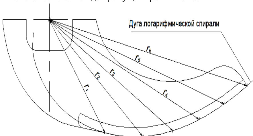
Рисунок 1 – Нож куттера, выполненный по форме логарифмической спирали
