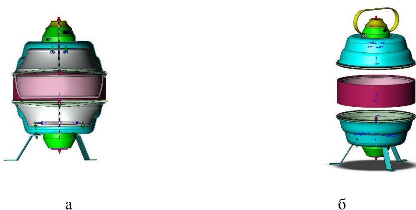
Рисунок 1 - Схема инфракрасного аппарата а – 3D-модель аппарата с двусторонним энергоподводом; б – разборная конструкция 3D-модели аппарата
