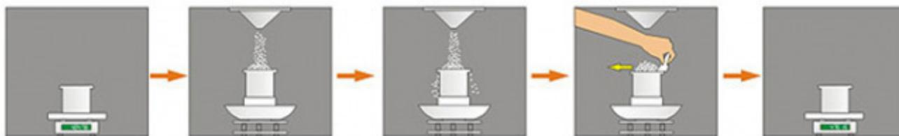
Рисунок 2 – Определение насыпной (объемной) плотности продукта
