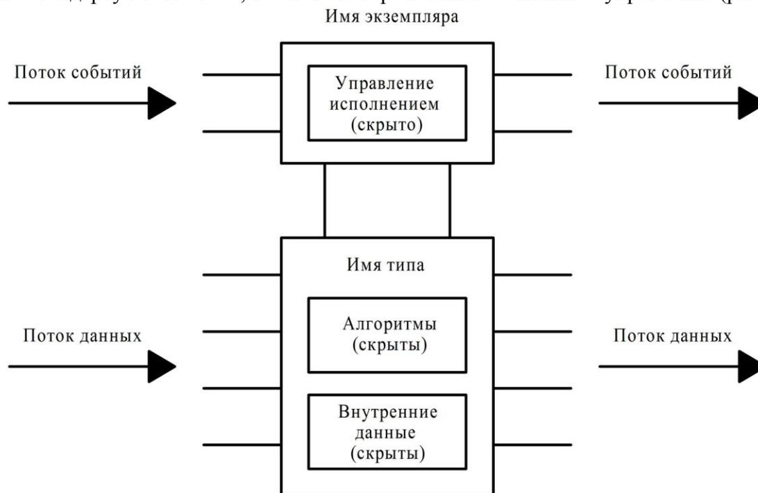
Рисунок 1 – Функциональный блок стандарта МЭК 61499
