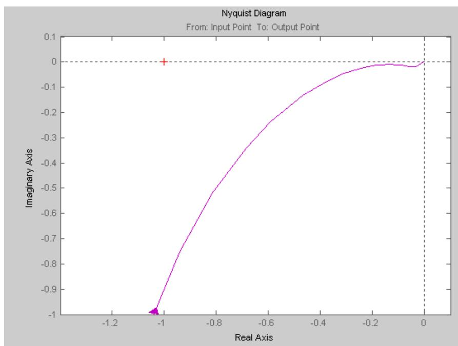
**Рисунок 4 – График АФЧХ для системы с ПИД-регулятором**
